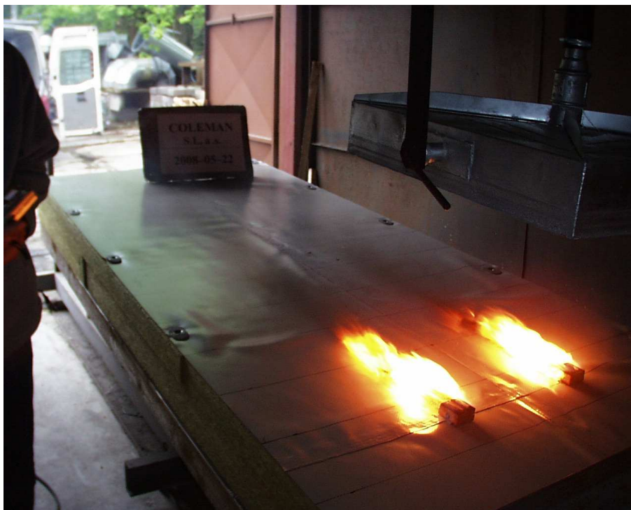
Foto č. 1 - Zkušební vzorek I (sklon 5°) po zahájení zkoušky
